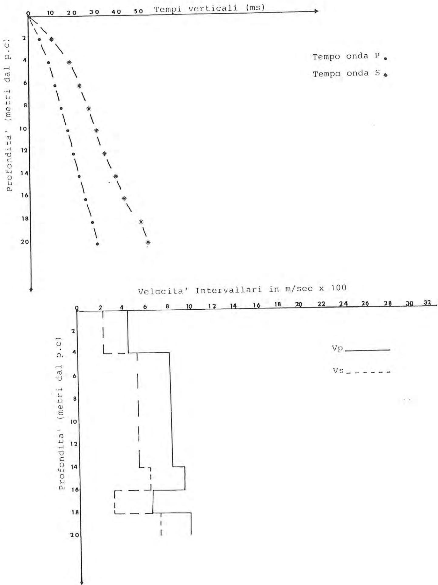
Parametri sismici relativi alla prova DOWN-HOLE numero 4
