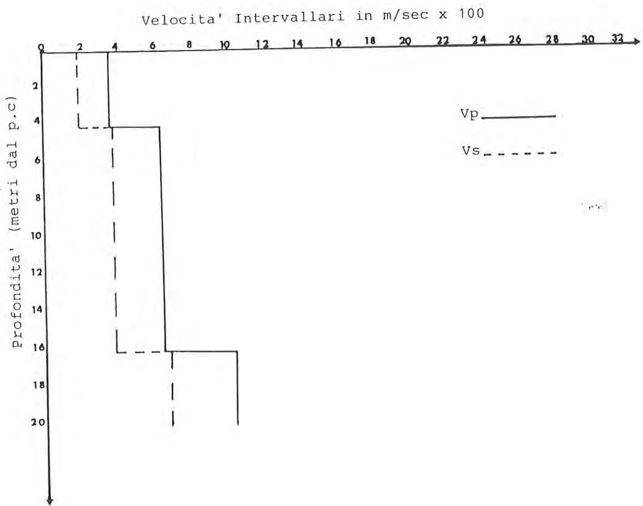
Parametri sismici relativi alla prova DOWN-HOLE numero 3
