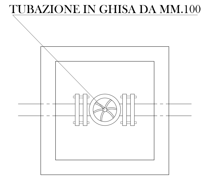
PIANTA TIPO POZZETTO PER SARACINESCA Scala 1:20
