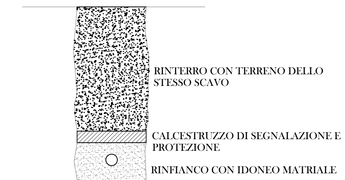
PARTICOLARE TUBAZIONE INTERRATA Scala 1:20
