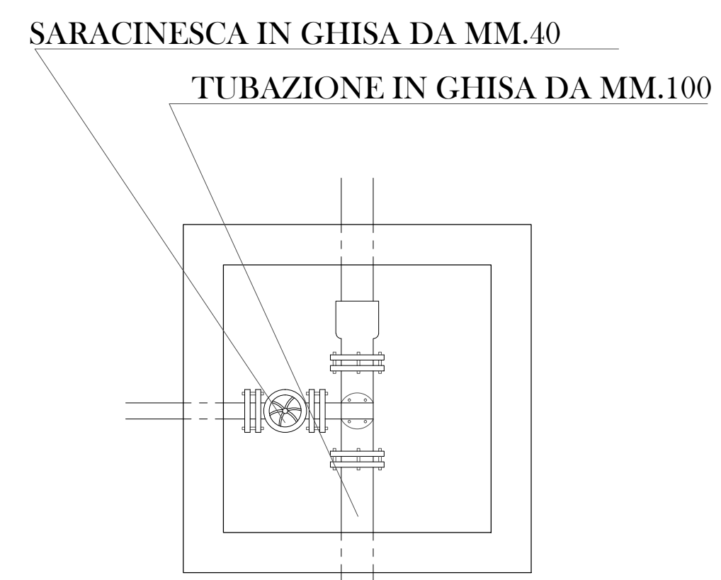
PIANTA TIPO POZZETTO PER ALLACCIO Scala 1:20
